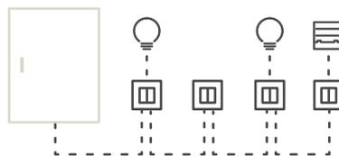
Выключатели подключаются на прямую к системе и управляют только устройствами, к которым они подключены напрямую
