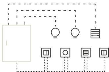
Выключатели подключаются к системе через программные настройки и могут управлять любым устройством без прямого подключения
